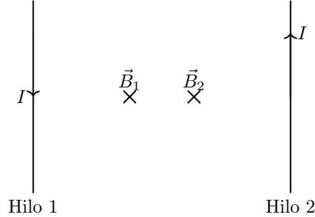
Aplicando la regla de la mano derecha, ambos campos magnéticos  $\vec{B}_1$  y  $\vec{B}_2$  apuntan en la misma dirección en el espacio entre los hilos. Entonces, el campo magnético total entre los hilos es:
