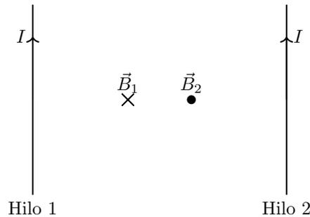
Aplicando la regla de la mano derecha, el campo magnético  $\vec{B}_1$  generado por el hilo de la izquierda entre los dos hilos es hacia dentro del plano (entrante), mientras que el campo magnético  $\vec{B}_2$  generado por el hilo de la derecha es hacia fuera del plano (saliente). Los módulos de los campos magnéticos en el punto equidistante entre los hilos son:
